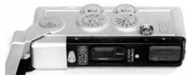
Le GaMi 16 ouvert, vue de face: levier du filtre jaune, sigle fabricant, fenêtre de l'objectif et du télémètre, fenêtre du viseur, une glissière sur la fenêtre d'objectif et un plot entre les 2 fenêtres servent au maintien des accessoires optiques.
