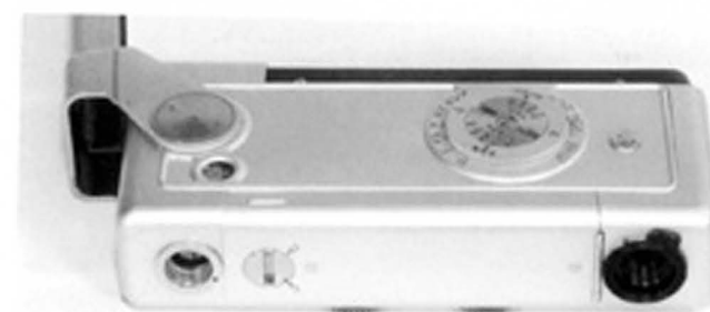
Le GaMi 16 ouvert, vue de l'arrière, de gauche à droite: écrou de pied/prise flash dont on distingue le contact, verrou fendu d'ouverture du dos, oculaire du viseur avec réglage dioptrique.
