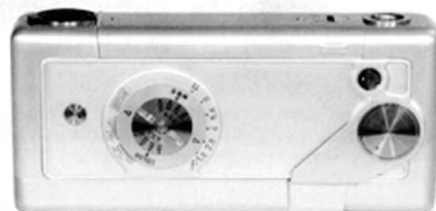
Le GaMi 16 fermé, vue du dessous: disque de réglage des diaphragmes avec d'un côté les symboles et de l'autre les ouvertures. Concentrique le disque de réglage de sensibilité du film. Compteur de vues.
